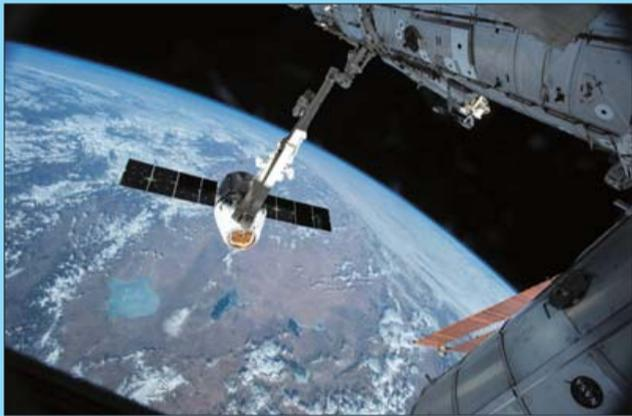
4月17日,NASA拍摄机械臂试图抓住SpaceX公司的“龙”载人飞船,并将其拉进国际空间站。
