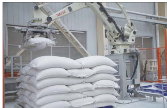
在低温豆粕车间，机械手正在码垛。
