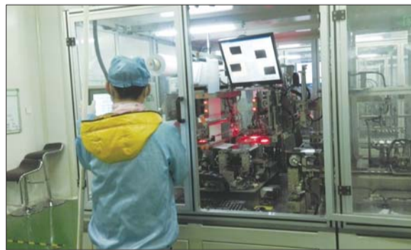
恒宇新能源有限公司的全自动五金贴膜机。
