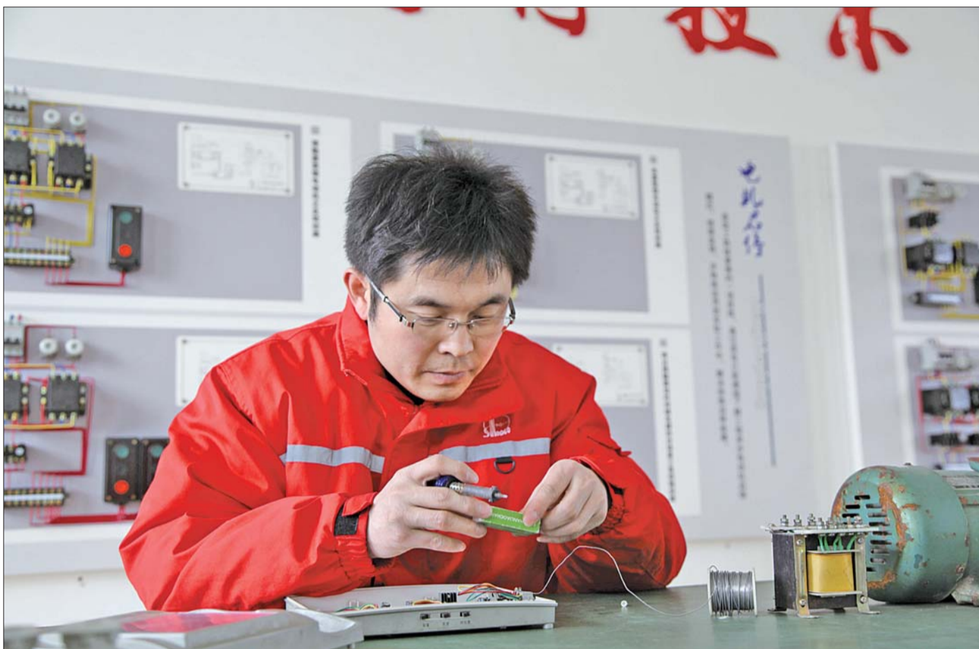
孙焱正在维修门禁对讲主机主板。
