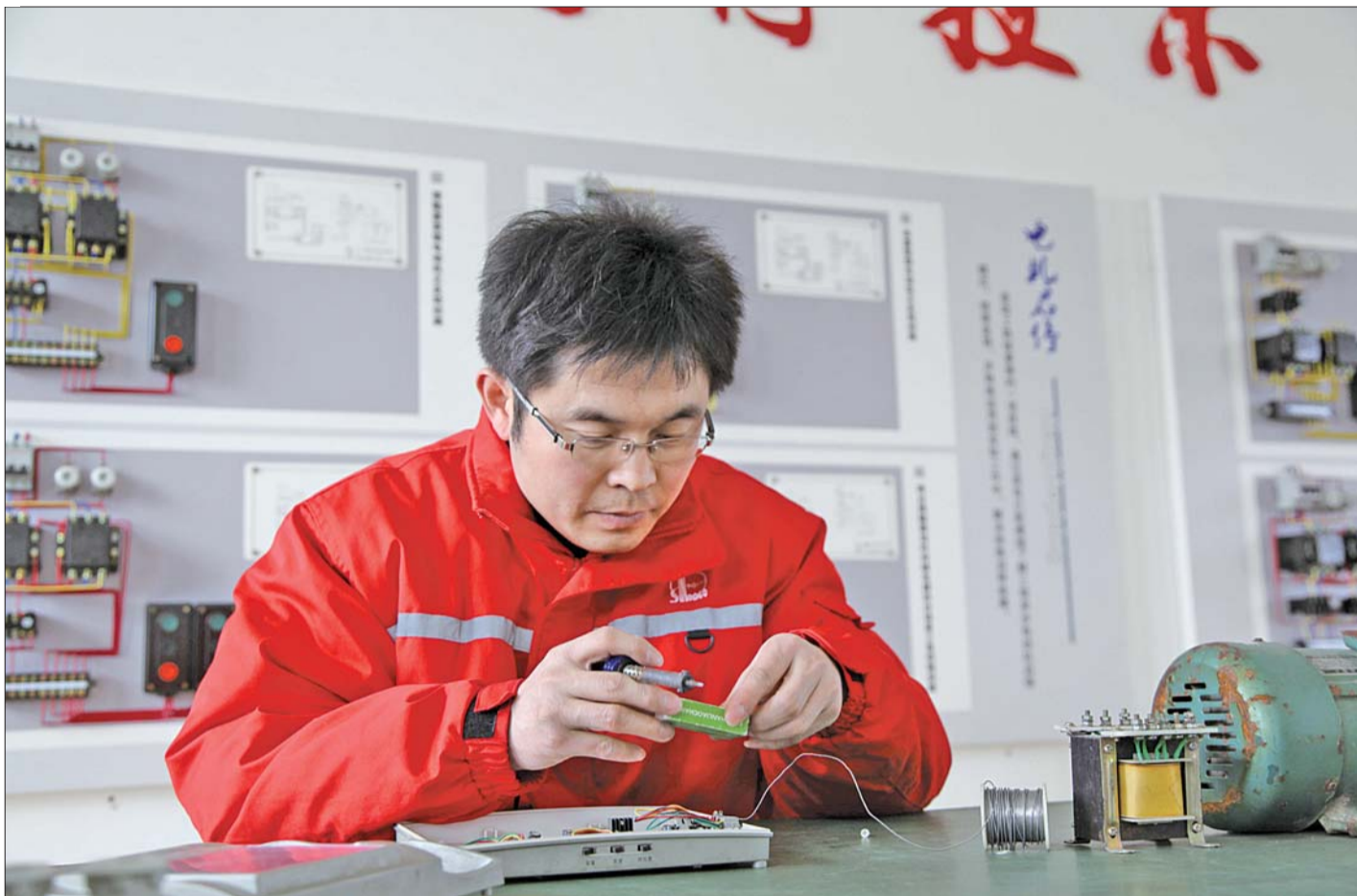
孙焱正在维修门禁对讲主机主板。
